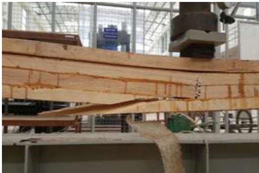
รูปที่ 12 คานวิบัติแบบดึงขวางเส้น
