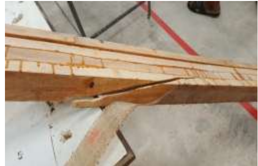
รูปที่ 13 ลักษณะการวิบัติของคาน
