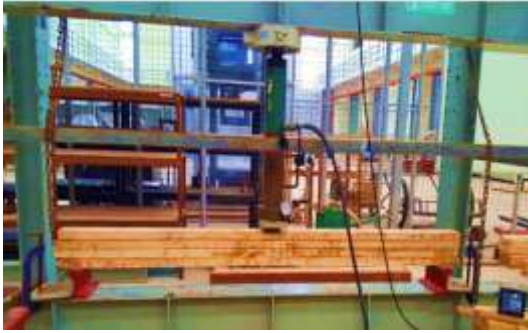
รูปที่ 10 ทดสอบกำลังรับน้ำหนักของคาน
