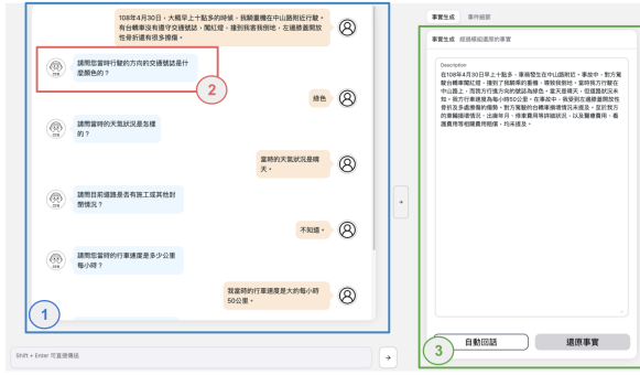
Figure 3: CCG 系統架設畫面預覽，(1) 為對話內容，根據聊天內容藉由資訊擷取模組產生交通事故資訊儲存格式。(2) 的對話內容根據提問模組產生。(3) 為事故經過生成模型。
